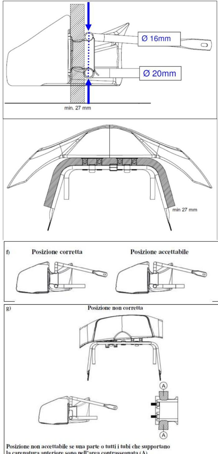
Le carenature laterali (plastiche) dovranno essere solidamente fissate ai supporti tramite la minuteria originale.
